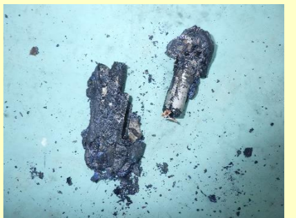
潰れて燃えた充電式電池
