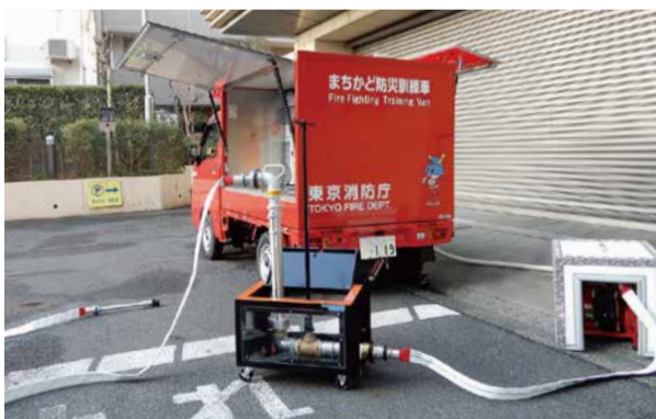
スタンドパイプを組立てた様子
