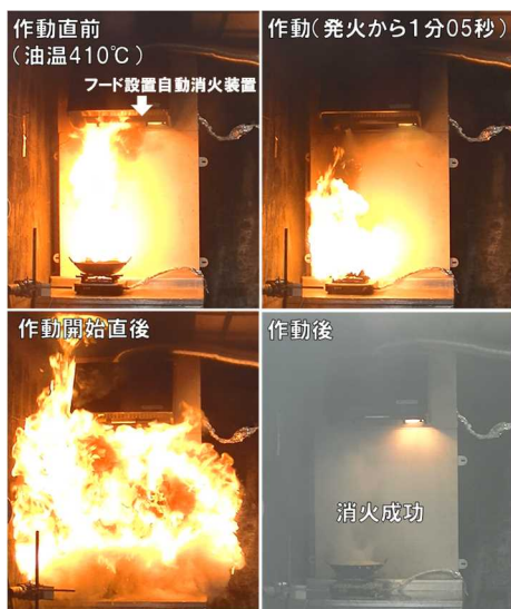
図 30 自動消火装置によるフード消火状況
