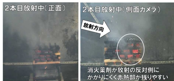
図34 エアゾール式スプレー消火具による普通火災火源消火状況
