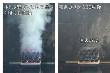
図16 ボトル型投てき消火具の叩きつけ消火状況
