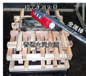
図7 消火具の取付状況
