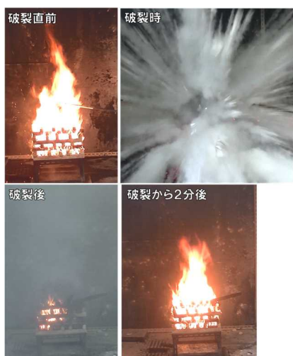
図 17 火薬破裂消火具による普通火災火源消火状況
