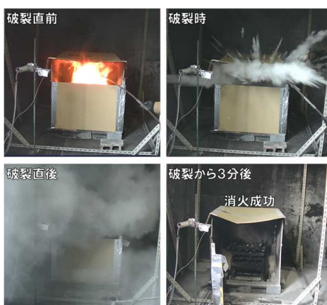
図 19 ボックス内消火状況
