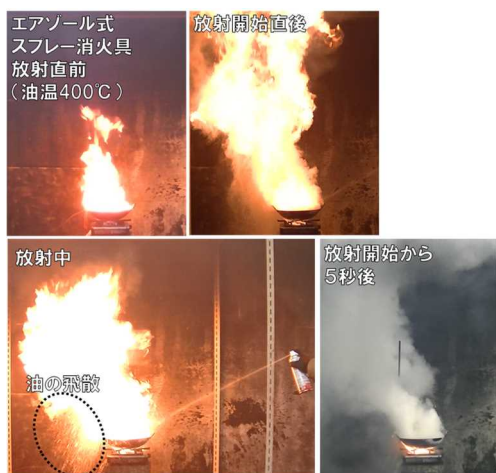
図 24 油火災火源の消火状況
