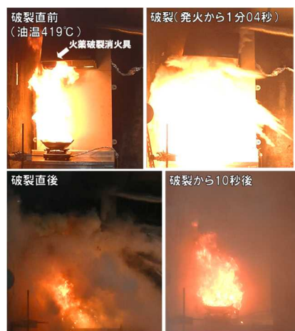
図 21 火薬破裂消火具によるフード消火状況
