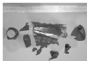
図 33 叩きつけ消火実施後のボトル型投てき消火具
