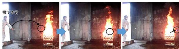
図 32 投てき消火具が火源に当たっても割れない様子
