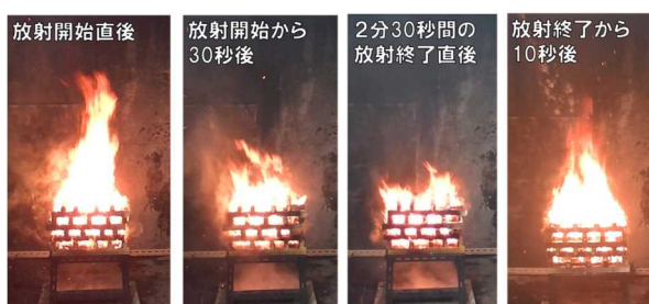
図 26 手動式スプレー消火具による消火状況
