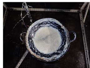
図35 鍋内の油が酸化した状況
