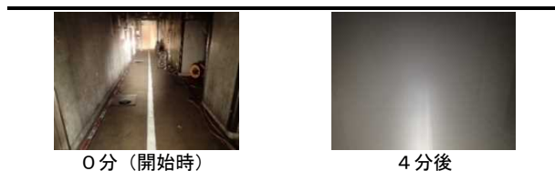
図17 白煙内で投光器照射時の反射ホースの見え方
