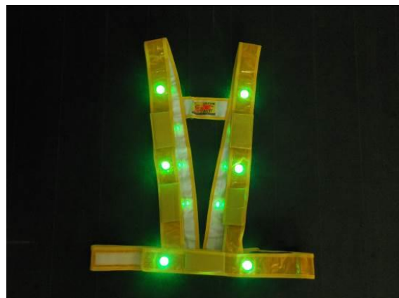
写真2 発光数を調整した安全チョッキ（6個）
