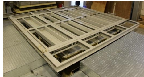
図2 拡張板を設置した振動発生装置の外観
