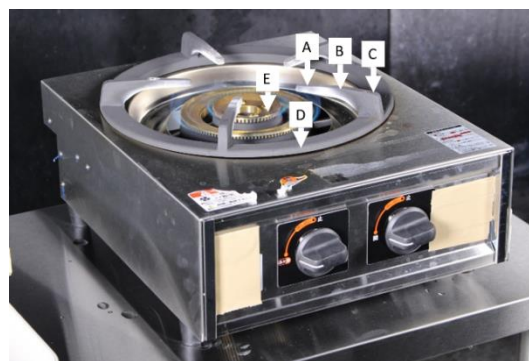
図 17 ガスこんろに対する油の滴下位置の設定
