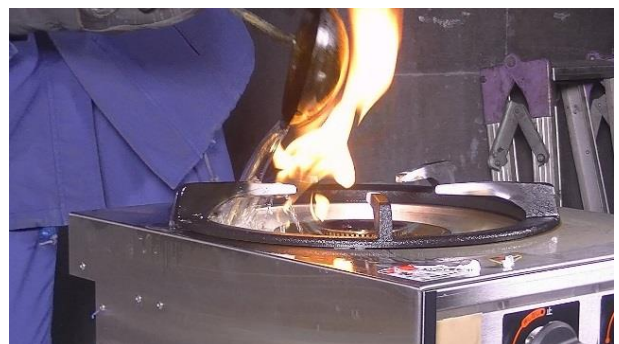
図 29 五徳先端部に 220℃の油を 100mL 滴下した時の着火状況
