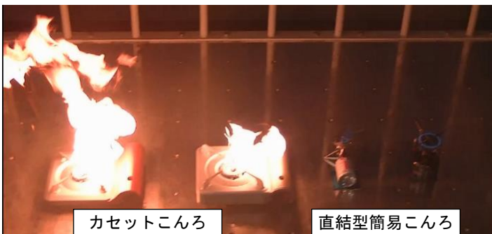
写真2 加振時のカセットこんろ等の燃焼状態（震度5強）
