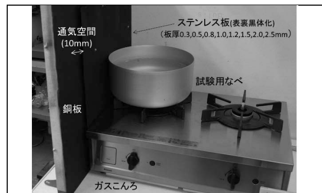
図6 特定不燃材料以外の仕上げ部分の受熱環境の予測
