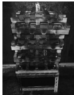
図 14 消火後の A 火災模型
