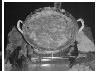
図 15 消火後の B 火災模型
