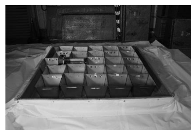
写真8 集水バケツの配置
