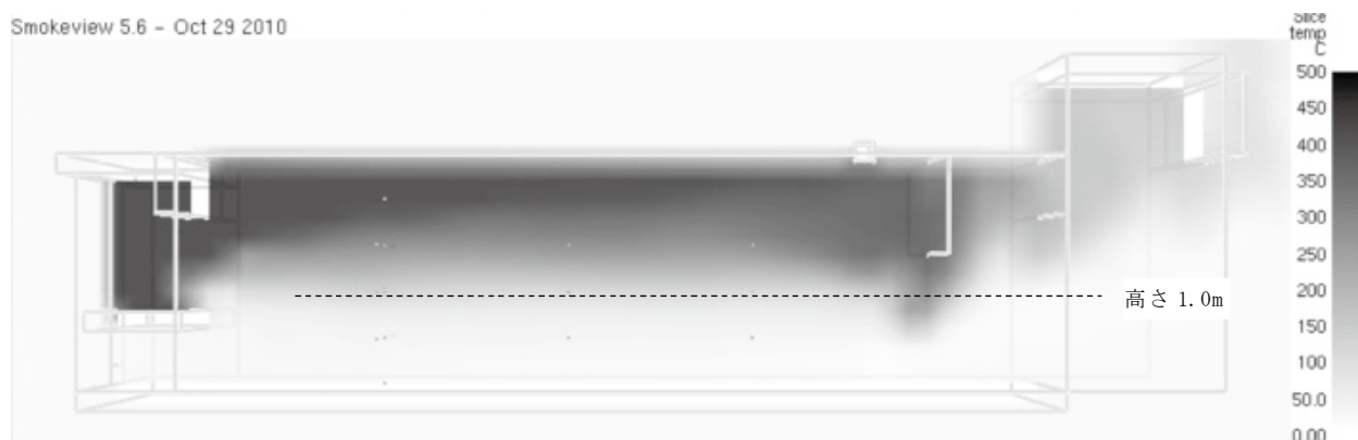
図 16 長辺断面の熱環境の可視化の状況（木質パレット5枚）（時刻約13分30秒）
