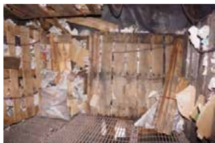
図4 木質パレット5枚と助燃材の設定状況
