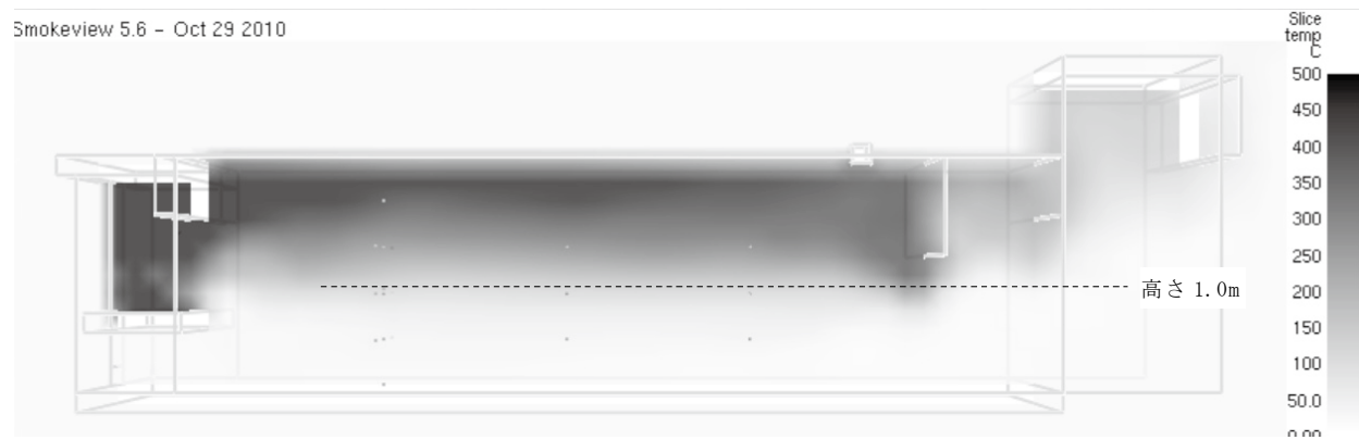
図 15 長辺断面の熱環境の可視化の状況（木質パレット5枚）（時刻約8分）
