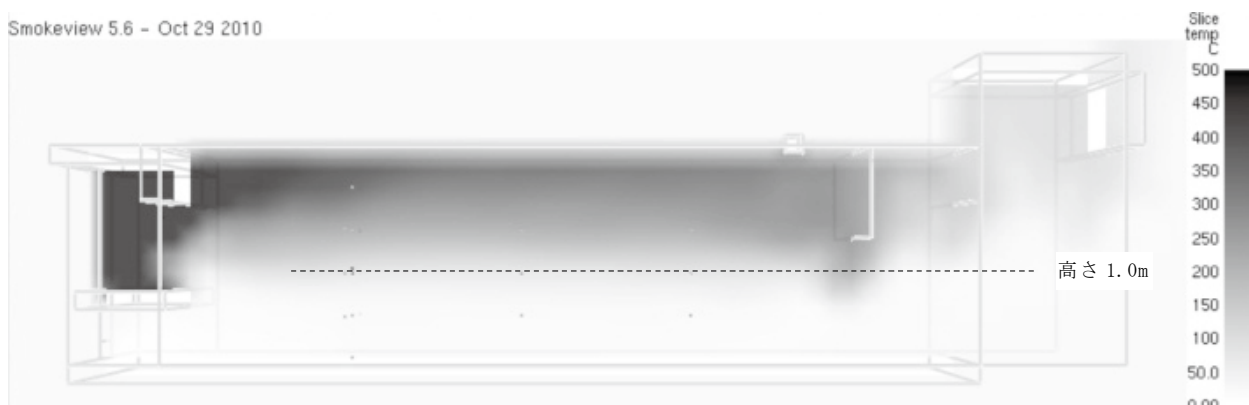
図 14 長辺断面の熱環境の可視化の状況（木質パレット5枚）（時刻約4分30秒）
