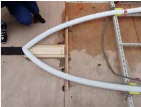
図8 V字摩耗実験
