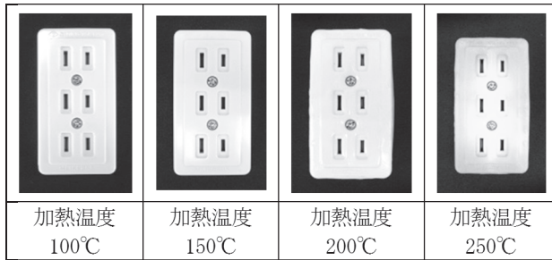
図9 恒温槽実験によるコンセントEの熱的变化
