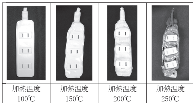
図10 恒温槽実験によるコンセントテーブルの熱的变化
