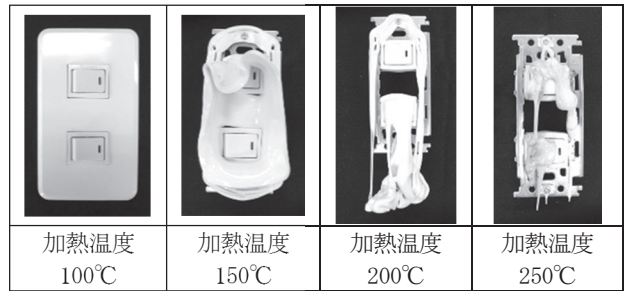
図13 恒温槽実験によるスイッチCの熱的变化
