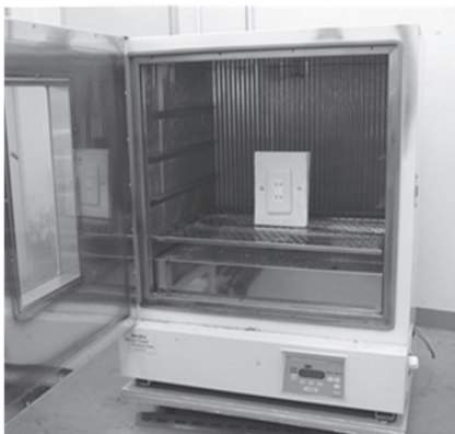
写真2 試験体(コンセントA)の設置状況(壁面設置)
