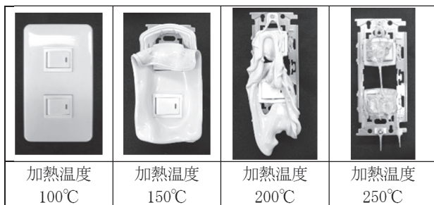
図11 恒温槽実験によるスイッチAの熱的变化
