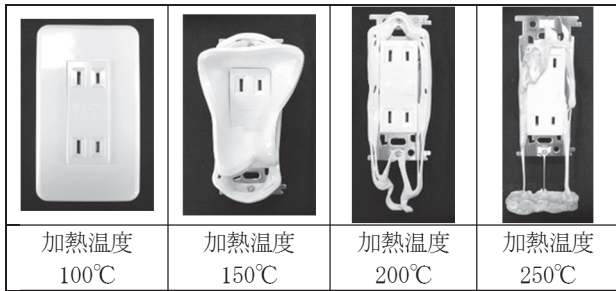
図8 恒温槽実験によるコンセントDの熱的变化
