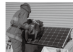
写真 24 破壊状況④ (エンジンカッターで破壊)
