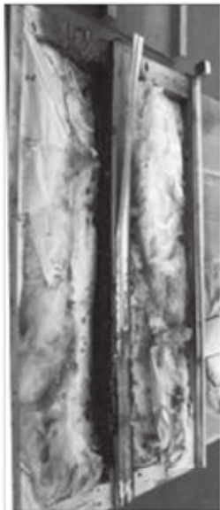
写真4 外装材取り外し 実験No. 8 充填断熱 厚さ 75mm
