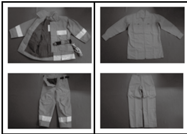
図2 モデル試料に使用した防火衣及び救助服
