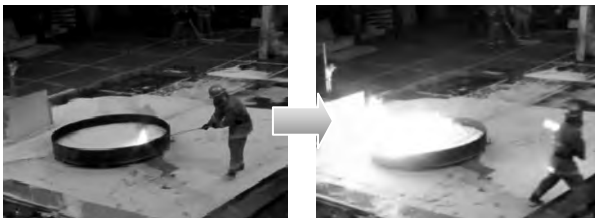
写真4 写真5 15分後の再着火の様子(実験6)
