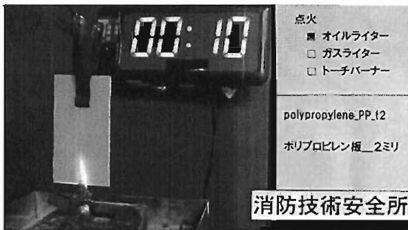
写真1 小規模試験状況 (ポリプロピレン板_2ミリ)
