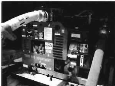
写真1 圧縮空気泡消火システム(CAFS)
