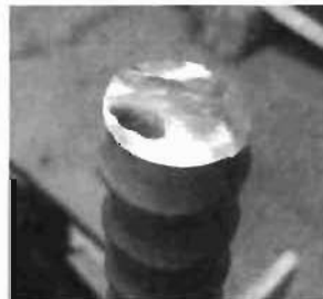
写真10 ディスクグラインダー(切削砥石)(D32)
