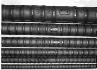
写真4 異形棒鋼(上から SD345 : D32、D22、D19、SD295A : D16、D13、D10)
