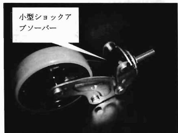
写真7 小型ショックアブソーバー付き車輪
