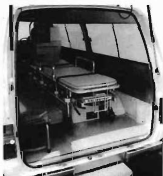
写真6 アンビュランスタイプの防振架台
