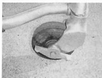
写真4 車輪ロックの構造
