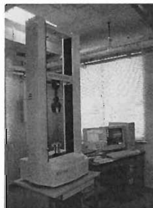
写真10 試験中の引張圧縮試験機 (島津製作所 AG-1 5kN)
