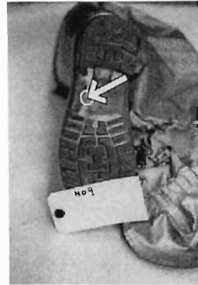
写真1 踏み抜きをおこした長靴 (図の白い矢印部分)
