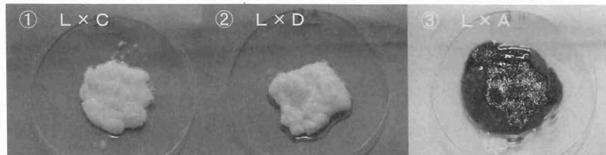
写真5 高分子ゲル泡消火薬剤Lと異種泡消火薬剤混合後に水を加えた時に生成する凝固物
