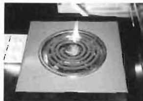
写真 17 電源遮断から 10 秒後、着火した状況
