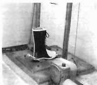
写真7 足甲プロテクタ試験図
