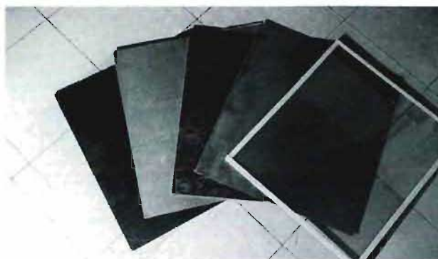
写真7 試料 (左から普通ガラス・制振塗料・鉛シート・制振シート・鉄板・二重ガラス)
