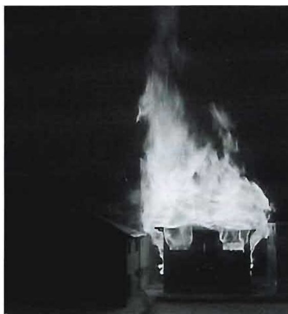
写真1 燃烧建物の炎の様子 (左側に4階建て建物、右側に2階建て建物が隣接している)
