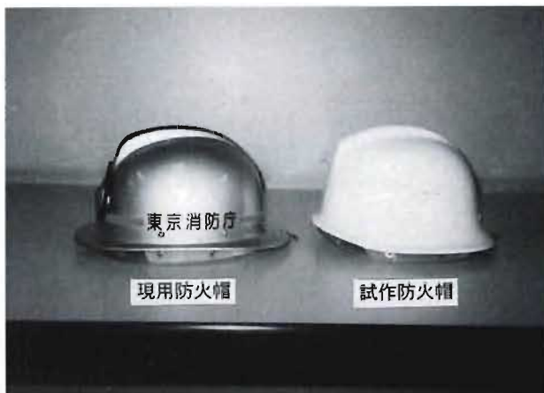
写真 4 試作防火帽と現用防火帽（側面）
