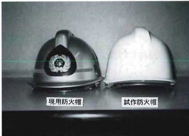
写真 3 試作防火帽と現用防火帽（正面）
