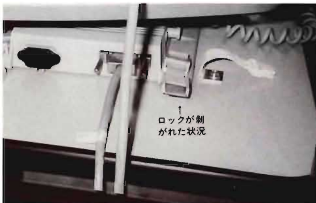
写真5 ディスプレイのロック方式固定が剥がれた状況 (3 Hz正弦波)
