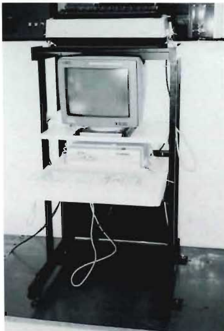
写真2 供試体の設置状況 (ラックを固定した状態)
