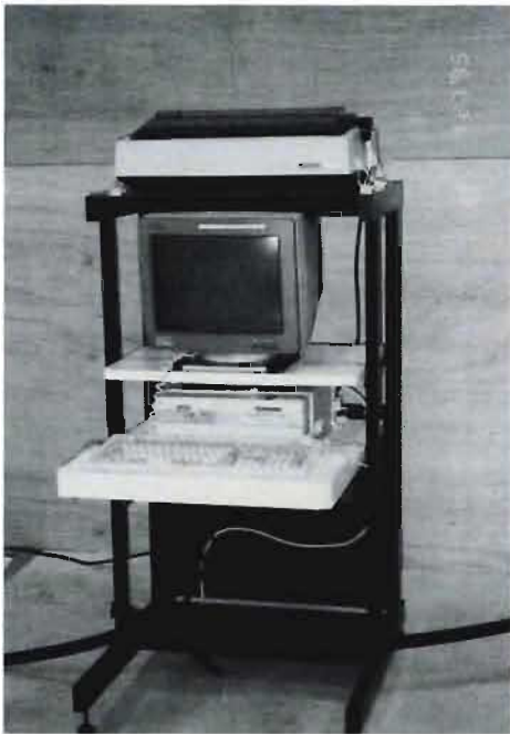
写真1 供試体の設置状況 (ラックを固定していない状態)
