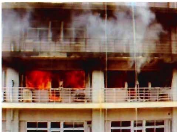
写真3-1 火災室の状況 (点火後21分)
