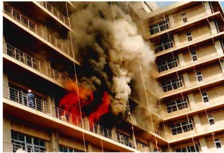
写真1 火災の噴出状況
