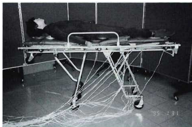
写真6 強度実験（静ひずみ）
