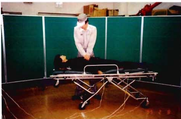
写真7 強度実験 (静ひずみ)
