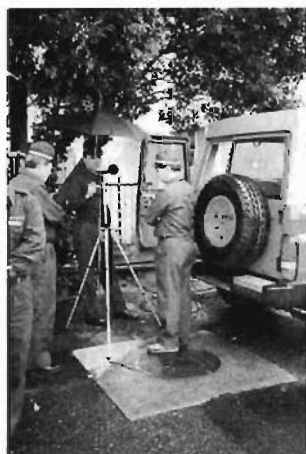
写真3 精密騒音計の設定状況
