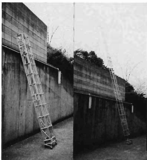
写真1 アルミ合金製三連はしごの外観
