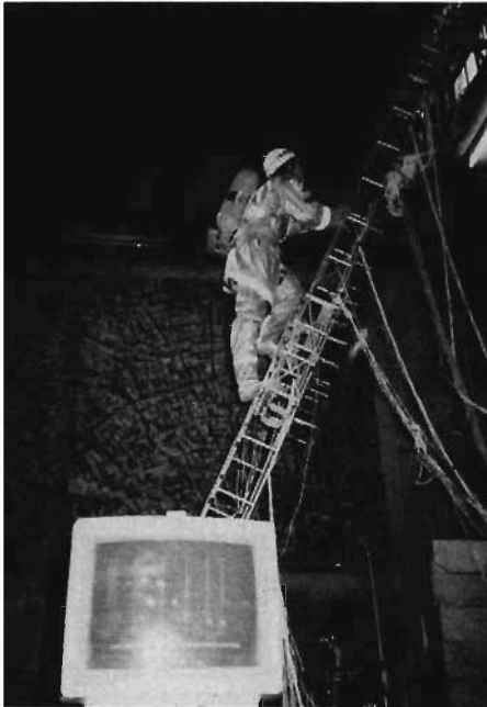
写真4 アルミ合金製三連はしご 架てい動荷重測定実験の概要
