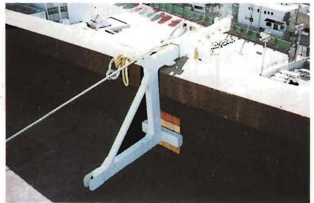
写真4 自在フック（下アーム式）を台付け用として使用した状態
