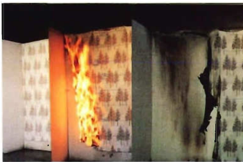
写真6 カーテンの消火実験(実験No.6)
