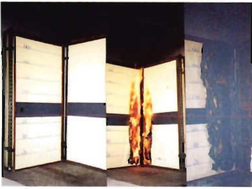
写真5 和襖の消火実験(実験No.3)
