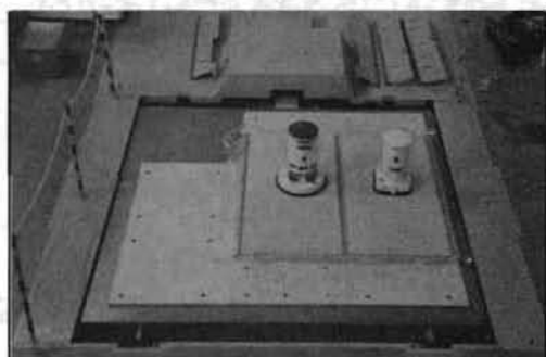
写真 二次元振動試験機を使用しての灯油ストーブの挙動実験
