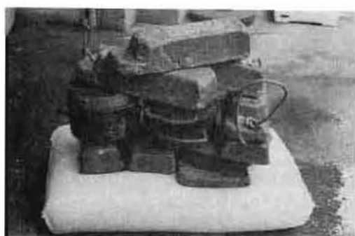
写真20 試験体Cの150kg荷重時の状況
