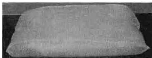
写真5 試験体Aの水道水吸水1分経過後
