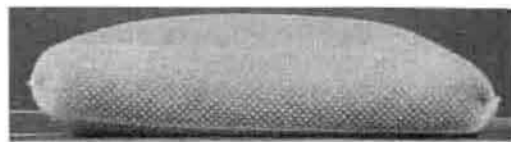
写真11 試験体Bの水道水最大吸水形状
