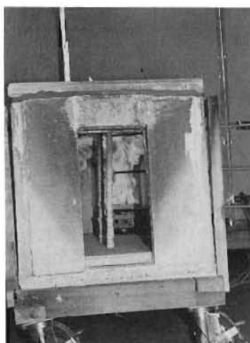
写真2 天井着火時の状況
