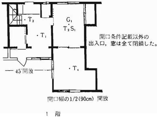
図3 開口条件及び測定点設置状況
