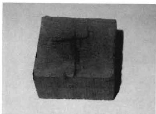
写真5 角材の内部の炭化状況(断面) (9cm角, 雰囲気170°C, 48時間加熱)
