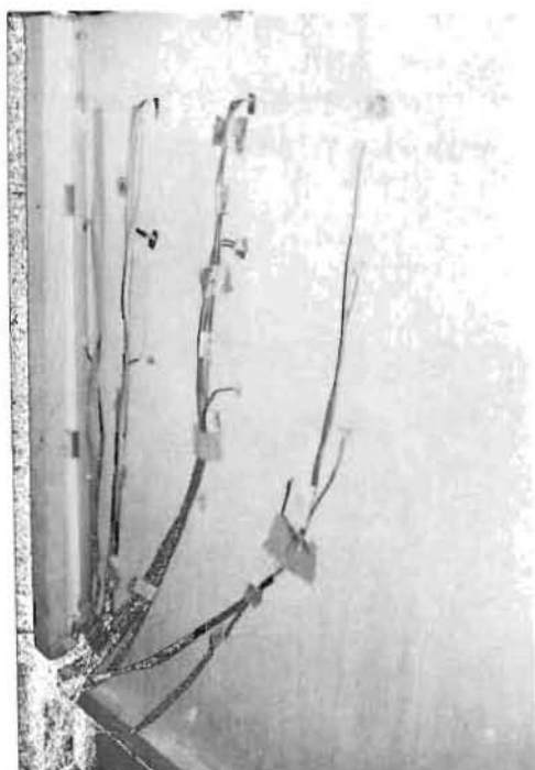
写真3 熱電対による壁体各部の温度測定
