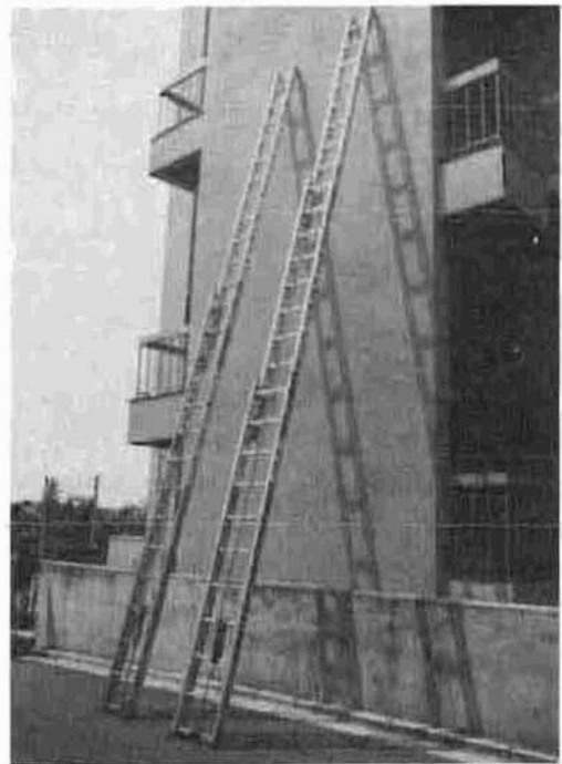
写真1 試作したアルミニウム合金製はしご 左側 二連はしご (試作1号機) 右側 三連はしご (試作3号機)
