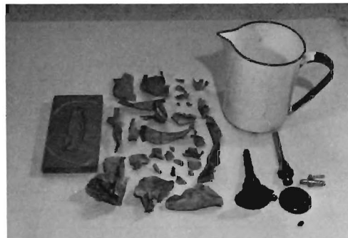
写真2 鉄製ホロービーカー及びバーナーとその破損状況
