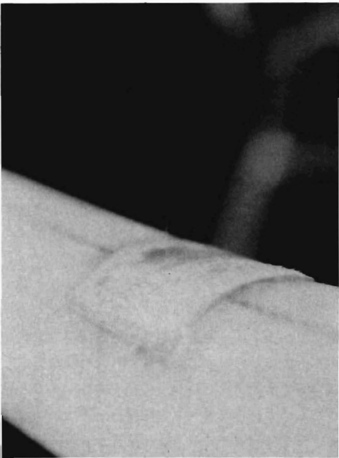
写真5 パッチから噴水の状況
