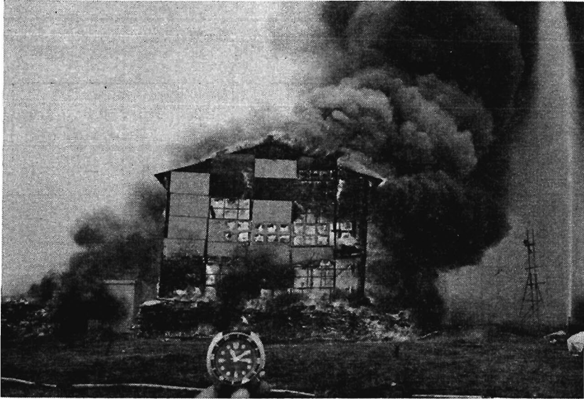
写真3 実規模火災における熱遮断実験
