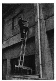
このレスキュー・タワーは、油圧で垂直に伸縮する 高所作業台、救助高さを自由に調節して連続的に救助 できるすべり台式救助袋、作業台の上に架ていまたは 屋内から上階へ架ていできる登ちよう用はしごからなり、これらを単体または組合わせることによつて、高 所からの人命救助および警防隊員の屋内進入を図るも ので、写真1、2のとおりである。
