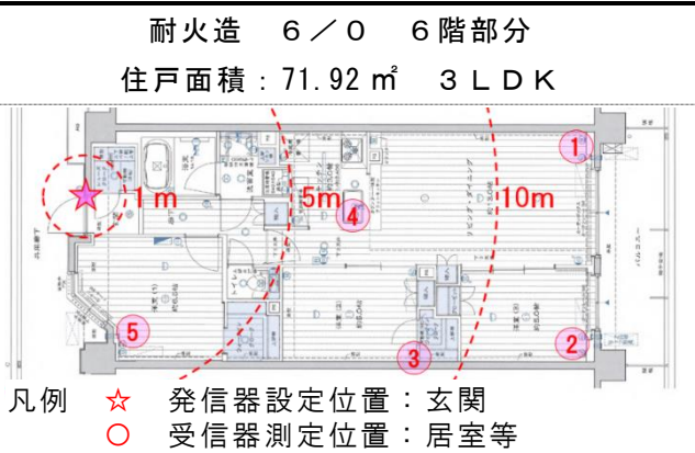
図3 実験場所（共同住宅：無線通信機器）
