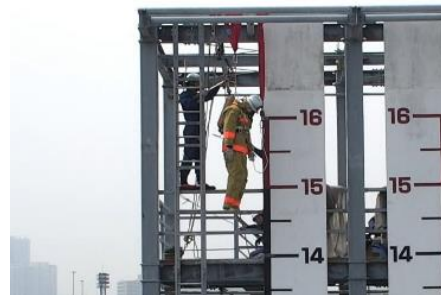
写真1 落下実験状況
