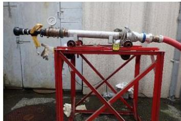
写真2 反動力の測定
