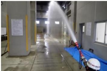
写真1 散水分布測定
