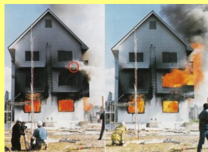
筑波市で行われた木造三階建住宅の実大火災 実験 フラッシュオーバー発生の瞬間の様子 (昭和63年)
