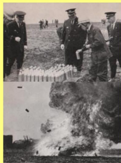
LPGガスボンベ貯蔵庫及びエアゾール製品の火災実験（東京港12号埋立地・昭和42年3月）
