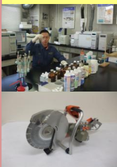
様々な薬品やコンピューターを活用しての鑑定風景（上）。企業・大学と共同開発した高圧水駆動カッター（下）
