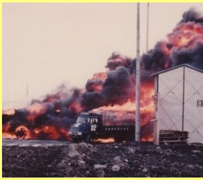
大規模自動車火災実験(東京港12号地埋立地・昭和50年12月)
