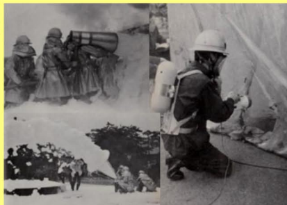
消防科学研究所試作機器の公開実験風景 手持ち式発泡器による車両消火実験（左上）、東消式発泡器による油火災消火実験（左下）、超音波式方向探知機（右）（昭和44年5月）
