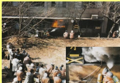
旧都立大久保病院跡地で行われた実大火災 実験 新型ノズルの消火実験が行われた(昭 和63年)
